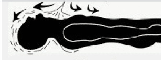
Etape 3 : rupture du cordon fluidique
